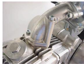
フレーム等の誤差により、キャブレターとフレームが干渉する場合があります。その場合は干渉部分を削り取して下さい。
