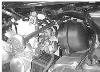
4. スロットルバルブをキャブレターから取り外し、スロットルバルブとスロットルケーブルを分離し、スロットルケーブルからトップカバーを抜き取ります。
