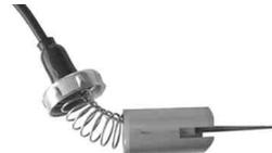
8. スロットルバルブの切り欠き部をスロットルストップスクリューに合わせてキャブレターに取り付けます。
