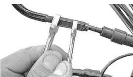
11. フューエルタンクを取り外していた場合、フューエルコックを付け替えて【規定トルク =  $5 \sim 6 \text{ N} \cdot \text{m}$
