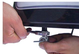
12. フューエルコックの方向、フューエルチューブの長さを調整し、フューエルコック、キャブレターに差し込みチューブクリップを取り付けます。フューエルコックを開き各部からのガソリン漏れの有無を確認します。(コックを開いたまま長時間放置しないで下さい。)
