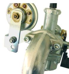
5. 付属のキャブレターのトップカバーを外しスロットルバルブスプリング、スロットルバルブを取り外します。スロットルケーブルにキャブレタートップを取り付けスロットルバルブスプリングを圧縮した状態でインナーケーブルをスロットルバルブに取り付けます。
