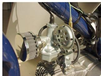
12. ガソリンを入れ、フューエルコックをONにし、各部からのガソリン漏れの有無を確認します。(コックを開いたまま長時間放置しないで下さい。)問題がなければ、チョークレバーを引きエンジンを始動させ各部からの吸気漏れの有無を確認します。チョークレバーを徐々に戻し、回転がスムーズになるまで暖機運転を行いチョークレバーを完全に戻します。エンジン暖気後アイドルリングしない場合や、アイドル回転数が高い場合は、スロットルストップスクリューで調整します。
