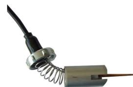
6. スロットルバルブの切り欠き部をスロットルストップスクリューに合わせてキャブレターに取り付けます。
