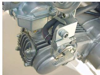
11. エアフィルターをキャブレターに取り付け、バンドを締め付けます。ホーンにコードを接続します。
