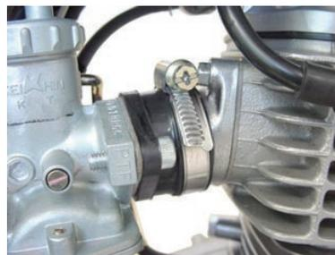
6. スロットルグリッパ部で5mm程度の遊びが出来るようにスロットルケーブルのアジャスターを調整します。スロットルを数回スナップさせ引っかかりやスロットルバルブの全開状態を確認します。
