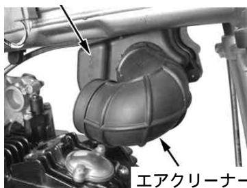
エアクリーナーダクト
