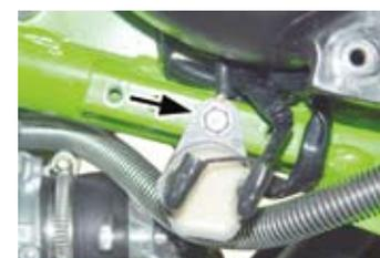
○シリンダーヘッドの丸印のボルト穴にインレットパイプを組み付けます。
