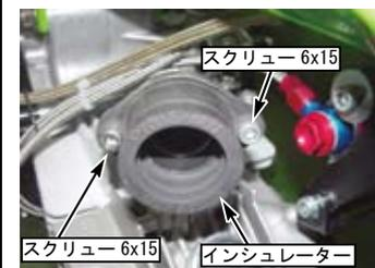
○キャブレターをインシュレーターに差し込み、バンドを締め付けて固定する。
