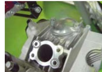
○シリンダーヘッドとインレットパイプの間にガスケットを挟み、ソケットキャップスクリュー 6x20 で取り付けます。
