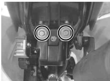
フューエルタンクとフレームをとめている左右のボルト/ワッシャと後部のバンドを取り外し、フューエルタンクを取り外す。
