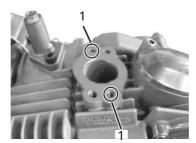
シリンダーヘッドとインレットパイプの間にガ スケットを挟み、ソケットキャップスクリュー M 6 × 2 0 を両側に取り付けます。
