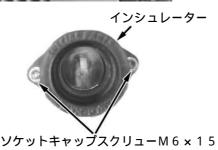
キャブレターのトップキャップを外し、スプリング、ニードルクリップリテーナー、スロットルバルブを抜き取ります。
