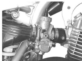
15. スロットルグリップ部で5mm程度の遊びが出来るように、スロットルケーブルのアジャスターを調整します。調整後はラバー製のアジャスターカバーをアジャスター部に被せて下さい。
