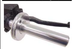
8. 左側ハンドルパイプ及び⑤スロットルパイプ COMP. のグリップラバー取り付け面と、⑧⑨ グリップラバー内面の汚れや油脂分を取り 除き、ハンドルパイプ及び⑤スロットルパイプ COMP. にホンダ純正: ホンダボンド A 又は、セメダイン #540 を薄く塗布し、接着面が乾かないうちに⑧⑨グリップラバーを回しながら取り付けて下さい。
