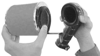
2. コネクティングチューブにクランプバンド ( 4 0 6 0 mm ) を通し、キャブレターに取り付けクランプバンドを締め付けます。
