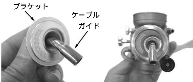
ケーブルガイド中心は、アジャストスクリューの反対側にオフセットしています。ブラケットの取り付けは必ず写真、図のように取り付けして下さい。インナーケーブルの破損、もしくはスロットバルブが全開にならない等の原因になります。
