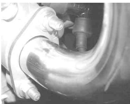
リアアームにキット内のマフラーステ-COMP.をキット内のキャップスクリュー10×25、8×50、スペーサー、プレーンワッシャ8mmを用いて取り付け締め付けます。
