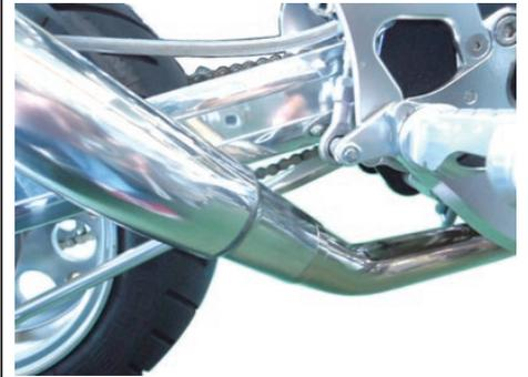
8. サイレンサー COMP. にエキゾーストパイプバンドを差し込み、サイレンサーを取り付けます。
