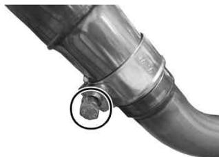
13. サイレンサーバンドを付属のソケットキャップスクリュー10×25、ブレンワッシャ10mmを取り付け締め付け、マフラスターに取り付けます。
