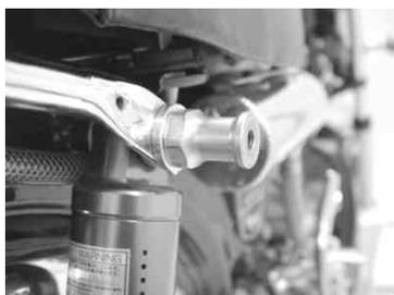
4. マフラーステーをピボットナットにソケットキャップスクリュー8×25用いて仮締めします。
