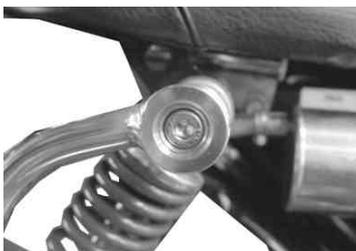
5. エキゾーストパイプをシリンダーヘッドエキゾースト側に差し込み、ジョイントナットを用いて仮締めします。
