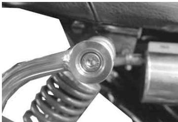
12. マフラーパイプジョイント部のバンド(36～39mm)を規定トルクまで締め付けます。
