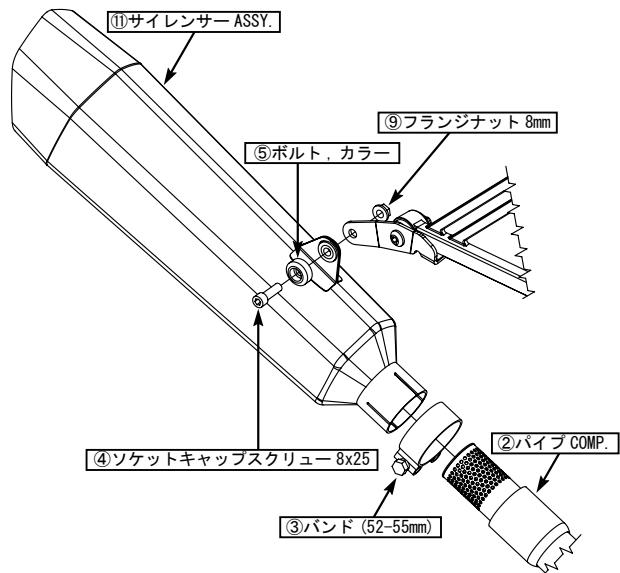
○各部に負荷がかからない様に調整してから④ソケットキャップスクリュー8x25、フランジナットを締め付けます。
