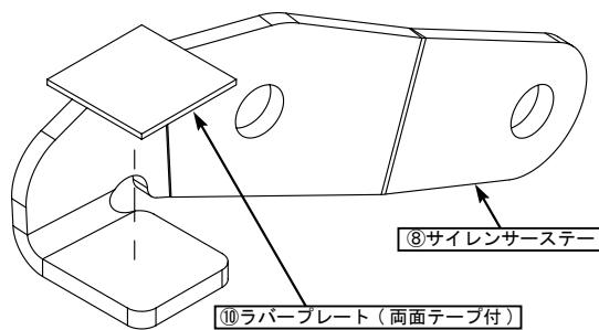
○車両の右側ステップブラケットに図を参考にして、⑧サイレンサーステーを取り付けます。
