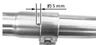
サイレンサーバンドを写真の様に取り付けキット付属のソケットキャップスクリュー10×25、ブレンワッシャ10mmを取り付け締め付けます。
