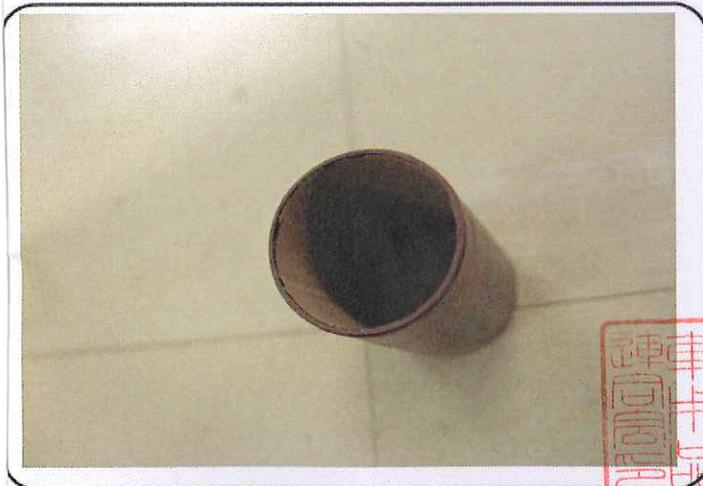
触媒の寸法 外径:  $\Phi 28.6$
