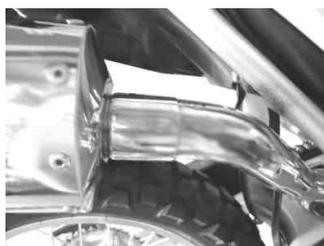
サイレンサーにエキゾーストパイプバンドを取り付けエキゾーストパイプに差し込みます。エキゾーストパイプバンドの取り付け位置は写真と同じ様に割り部分が約5mm程度見える位置に仮締めして取り付けを行って下さい。
