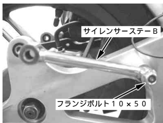
ブレンワッシャ 10mm 六角ボルト 10×60 フランジボルト10×50 サイレンサーステーA
