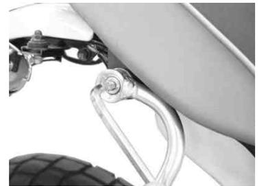
16. 各マフラー部の締め付けが完了すればエキゾーストパイプバンドを締め付けます。
