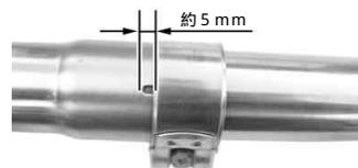
13. サイレンサーバンドを付属のソケットキャップスクリュー10×2.5、プレーンワッシャ10mmを取り付け締め付けます。
