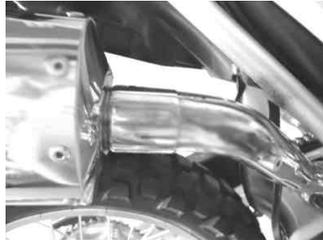
12. サイレンサーにエキゾーストパイプバンドを取り付けエキゾーストパイプに差し込みます。
