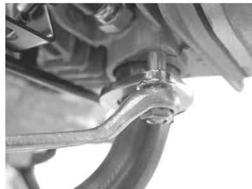
14. マフラステーCOMP ステー部のアクスルナットを規定トルクで締め付けます。
