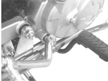
12. サイレンサーにエキゾーストパイプバンドを取り付けエキゾーストパイプに差し込みます。エキゾーストパイプバンドの取り付け位置は写真と同じ様に割り部分が約5mm程度見える位置に仮締めして取り付けを行って下さい。エキゾーストパイプバンドのネジ部には必ず焼き付き防止の為、潤滑油又は焼き付き防止剤を少量塗布して下さい。
