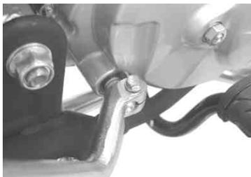
5. リアアクスルスリーブナットを外し、純正マフラーを取り外します。
