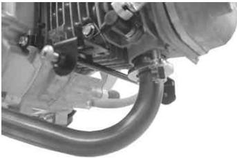
9. 右側リアショック部のピボットナットにサイレンサーステー、ソケットキャップスクリュー8×25を仮締めします。
