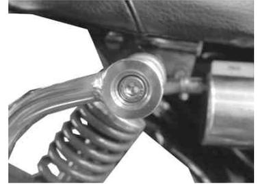
16. サイレンサーバンドを付属のソケットキャップスクリュー10×25、ブレンワッシャ10mmを取り付け締め付けます。
