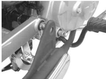
6. 右側リアショック上部ピボットナットを取り外し、キット内のピボットナットを取り付け、規定トルクで締め付けます。
