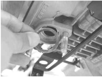
8. エキゾーストパイプをシリンダーヘッドエキゾーストポートに差し込みキット内のエキゾーストパイプフランジを使用し、エキゾーストパイプナット2個を用いて取り付け、仮締めします。
