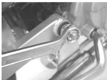
15. マフラステー上部のソケットキャップスクリューを規定トルクで締め付けます。
