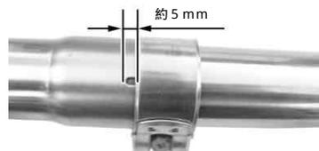
7. サイレンサーバンドを付属のソケットキャップスクリュー10×25、プレーンワッシャ10mmを取り付け締め付けます。
