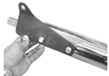
4. サイレンサーCOMP.ジョイント部を、エキゾーストパイプストッパー部に当たるまで差し込み、リアアクスルシャフト部に、ステアーを図を参考に取り付け仮締めします。
