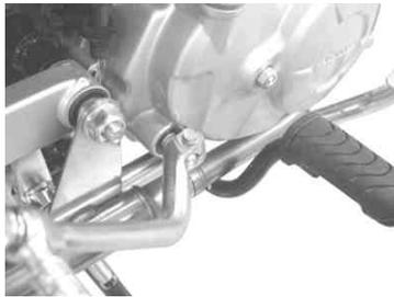
9. フレームのセンタースタンドストッパー部が当たる部分にキット同梱のラバープレートフレームに貼り付け、両サイドをインシュロックタイでロックし、余った先端をニッパ等で切断します。
