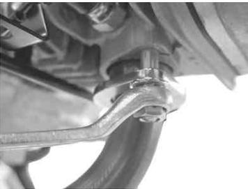
6. リアアクスルスリーブナットを規定トルクまで締め付けます。
