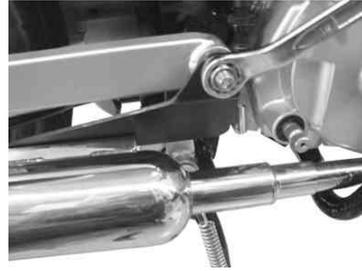
6. ステー部のフランジボルトを規定トルクまで締め付けます。
