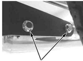
7. キックスターアームを取り付け、ボルトを規定トルクまで締め付けます。
