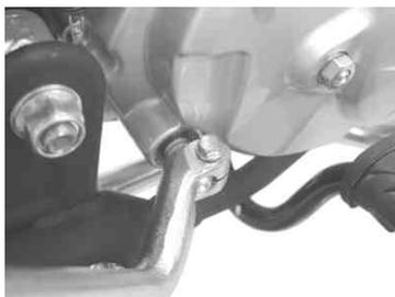
5. エキゾーストポート部の古いエキゾーストパイプガスケットを外しキット内の新品のエキゾーストパイプガスケットを取り付けます。
