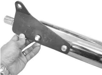
3. サイレンサーCOMP ジョイント部を、エキゾーストパイプストッパー部に当たるまで差し込み、リアアクスルシャフト部に、ステーを図を参考に取り付け仮締めします。
