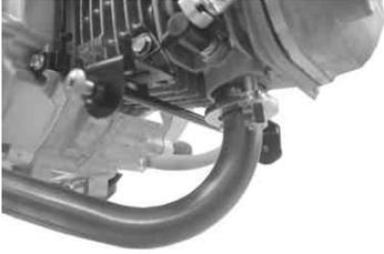
2. キット内のステーとサイレンサーCOMP をキット内のフランジボルト8×16を用いて取り付け、仮締めします。
