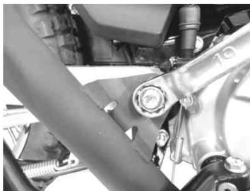
8. ステアを止めているフランジボルト2本を規定トルクまで締め付けます。
