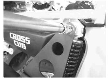
10. エキゾーストパイプジョイント部にバンドを移動させてバンドを規定トルクまで締め付けます。
