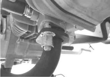
2. マフラーCOMPのサイレンサー部にステアをキット内のフランジボルト8×122本を用いて仮締めします。
