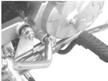
8. フレームのセンタースタンドストッパー部が当たる部分にキット同梱のラバープレートフレームに貼り付け、両サイドをインシュロックタイでロックし、余った先端をニッパ等で切断します。
