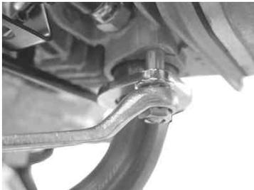
5. リアアクスルスリーブナットを規定トルクまで締め付けます。
