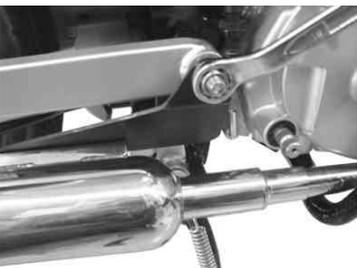
6. ステア部のフランジボルトを規定トルクまで締め付けます。
