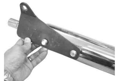
3. サイレンサーCOMP.ジョイント部を、エキゾーストパイプストッパー部に当たるまで差し込み、リアアクスルシャフト部に、ステアを図を参考に取り付け仮締めします。マフラージョイント部に耐熱ガasketの塗布をお勧めします。
