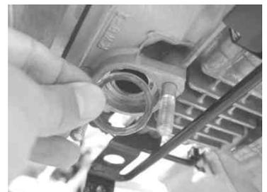
7. マフラーステーが取り付けられていたアクスル部のワッシャ、アクスルナットを取り付け規定トルクまで締め付けます。
