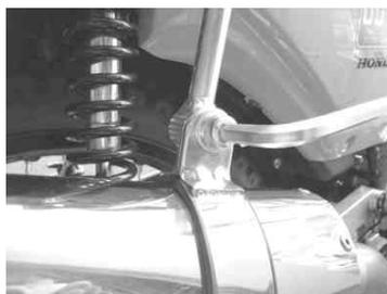
9. サイレンサーCOMP.のパイプジョイント部クランプバンドを規定トルクまで締め付けます。
