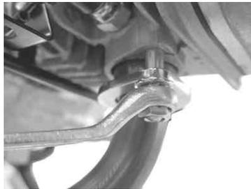
7. サイレンサーステー上部のソケットキャップスクリューを規定トルクまで締め付けます。
