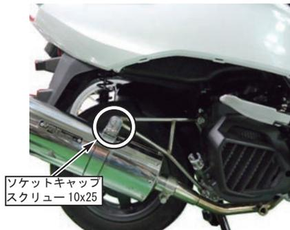
○サイレンサー COMP. ジョイント部のバンド 44-47mm を規定トルクまで締め付けます。
