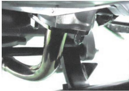
○エキゾーストパイプジョイント部に耐熱ガスケットを薄く塗布します。
