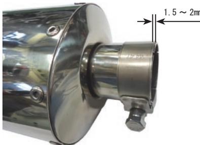
○サイレンサーバンドを付属のソケットキャップスクリュー 10x25、ブレーンワッシャ 10mm で取り付けます。
