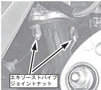
○サイレンサステーを取り付け、規定トルクまで締め付けます。
