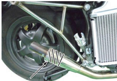
○サイレンサー COMP. のジョイント部に、バンド 44-47mm を取り付け、エキゾーストパイプに差し込みます。
