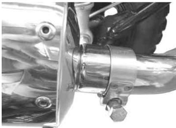
9. サイレンサーバンドを付属のソケットキャップスクリュー10×2.5、ブレンワッシャ10mmを取り付けます。
