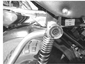
12. サイレンサーバンド部のソケットキャップスクリュー10×2.5を規定トルクまで締め付けます。
