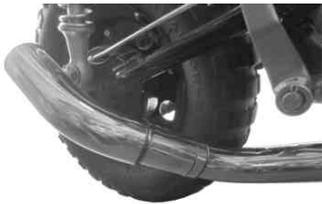
8. サイレンサーCOMP. にエキゾーストパイプバンドを差し込み、サイレンサーを取り付けます。
