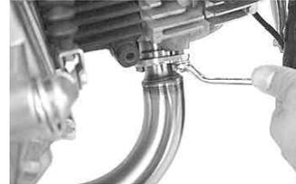
11. マフラスター上部のソケットキャップスクリューを規定トルクで締め付けます。
