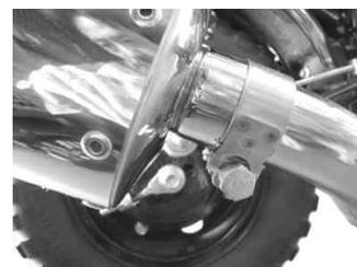
14. サイレンサー部のプレート及び保護フィルムを剥がします。
