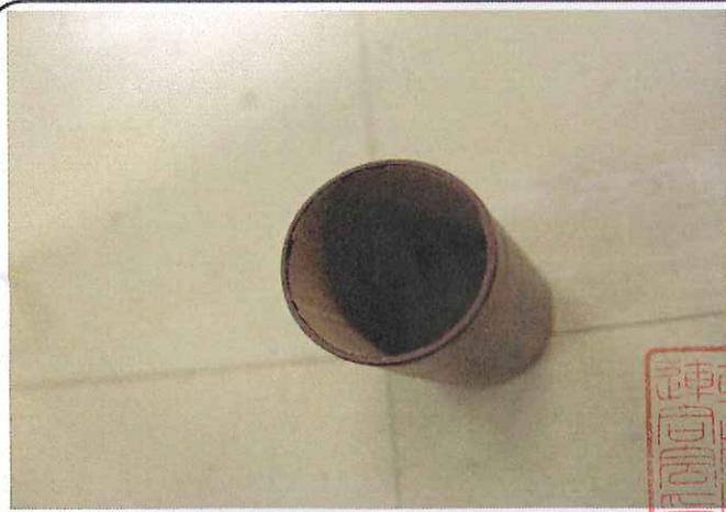
触媒の寸法 外径:  $\Phi 28.6$
