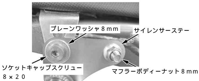
車両に取り付けられているエキゾーストパイプにセンターパイプを取り付けます。
