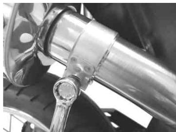
O<sub>2</sub> センサーを組み付けます。
