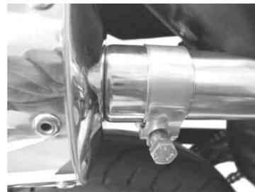
エキゾーストパイプバンドの取り付け位置は写真と同様な位置に仮締めして取り付けを行って下さい。
