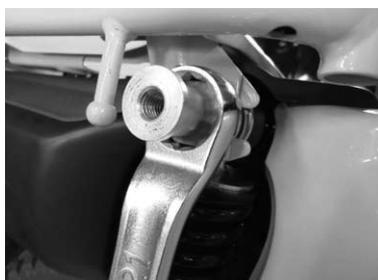
○エキゾーストポート部の古いエキゾーストパイプガスケットを外し、⑨エキゾーストパイプガスケットを取り付けます。
