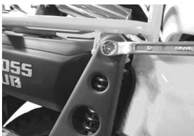
○②エキゾーストパイプジョイント部に⑧バンドを移動させて⑧バンドを規定トルクまで締め付けます。
