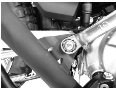
○サイレンサーステア上部の⑤フランジボルト 8x20 を規定トルクまで締め付けます。
