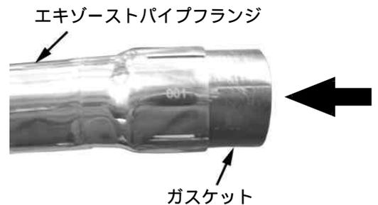
エキゾーストパイプフランジにノーマルのクランプを取り付けます。エキゾーストパイプには一部、幅の広い切り欠きが存在します。幅の広い切り欠き部分とクランプの突起を合わせ取り付けます。クランプには取り付け位置が存在するので、適当な位置でクランプを組み付けたい様にして下さい。
