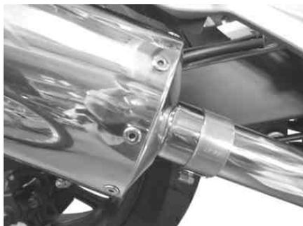
サイレンサーバンドラバーをサイレンサーバンドに取り付け、サイレンサーに取り付け、Rステップホルダーに取り付けたステー部にキット内のカラーを間に挟み、キット内のボタンヘッドソケットスクリュー10×30、フランジナットを用いて取り付け、規定トルクで締め付けます。
