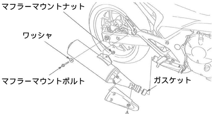
キット内のステーをR.ステップホルダー裏側にキット内のフランジソケットキャップスクリュー 8×16 及びノーマルのマフラーマウントボルト、マフラーマウントナットを用いて取り付け、規定トルクで締め付けます。
