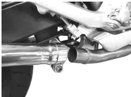
キット内のクランプバンドをサイレンサーCOMP.のジョイント部に取り付け、エキゾーストパイプに差し込み取り付けます。
