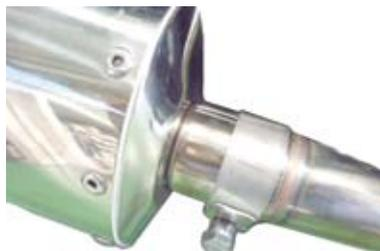
○オーバルサイレンサー COMP. にサイレンサーバンドを挟み込む様に取り付け、付属のソケットキャップスクリュー 10x25、ワッシャ 10mm を上下に取り付け、サイレンサーバンドを仮締めします。
