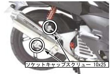
○取り付けが完了すれば、エキゾーストパイプナット、サイレンサーステー B、サイレンサーバンド、バンド 44-47mm の順に取り付けたボルトを規定トルクまで締め付けます。
