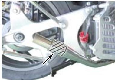
○オーバルサイレンサー COMP. にバンド 44-47mm を取り付けエキゾーストパイプに差し込みます。
