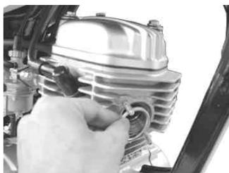
3. 右側のシートを取り付けている六角フランジボルトを取り外します。
