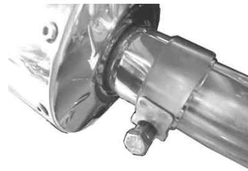
10. サイレンサーバンドにサイレンサーバンドラバーを巻き付けてサイレンサーに取り付け、ソケットキャップスクリュー 10×25、プレーンワッシャ 10mm を用いて取り付け仮締めします。
