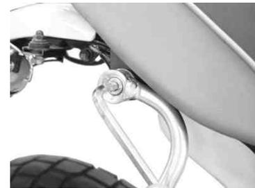
13. サイレンサーバンド部のソケットキャップスクリュー 10×25 を規定トルクで締め付けます。
