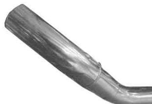
8. センターパイプとサイレンサーASSYの差し込み部に、エキゾーストパイプバンドを差し込みます。
