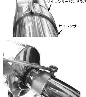
13. シリンダーヘッドEXポート部のS T D ナットを均等に規定トルクで締め付けます。
