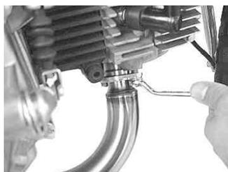
10. マフラスター上部のソケットキャップスクリューを規定トルクで締め付けます。
