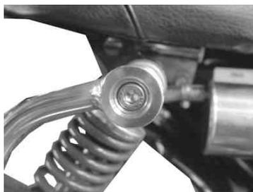
11. サイレンサーバンドを付属のソケットキャップスクリュー10×25、ブレンワッシャ10mmを取り付け締め付けます。
