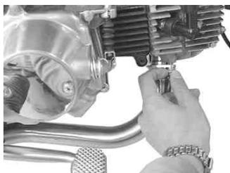
6. エキゾーストパイプジョイント部に耐熱ガスケット材を薄く塗布します。
