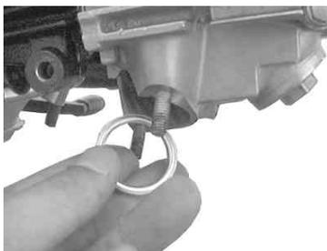
3. 右側リアショック上部のナットを取り外し、キット内のピボットナットを取り付け、規定トルクで締め付けます。
