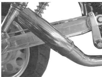
8. サイレンサーにエキゾーストパイプバンドを取り付けエキゾーストパイプに差し込みます。エキゾーストパイプバンドの取り付け位置は写真と同じ様に割り部分が約5mm程度見える位置に仮締めして取り付けを行って下さい。エキゾーストパイプバンドのネジ部には必ず焼き付き防止の為、潤滑油又は焼き付き防止剤を少量塗布して下さい。
