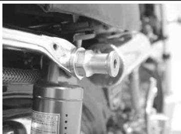
4. マフラスターをピボットナットにソケットキャップスクリュー8×25用いて仮締めします。
