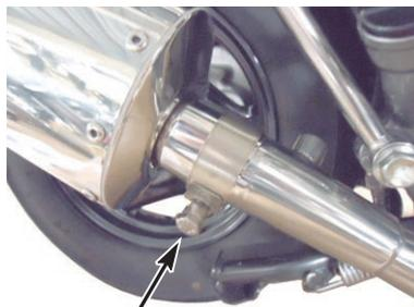
13. センサー付車両の場合、取り付けしたO<sub>2</sub>センサーを規定トルクで締め付けます。
