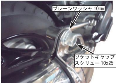
9. サイレンサーステー取り付け部の純正ボルトを規定トルクで締め付けます。
