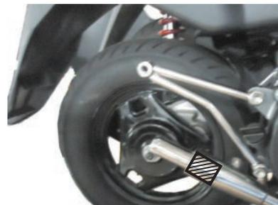
6. サイレンサーにエキゾーストパイプバンドを取り付けエキゾーストパイプに差し込みます。
