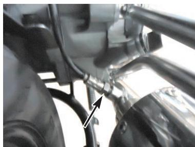
14. 取り付けが完了すればマフラーに付着した汚れを良く拭き取り、換気の良い場所でエンジンを始動し、排気漏れの有無を確認します。
