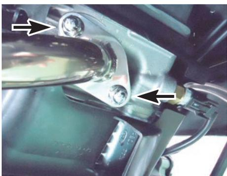
サイレンサーバンド部のソケットキャップスクリュー 10x25 を規定トルクまで締め付けます。
