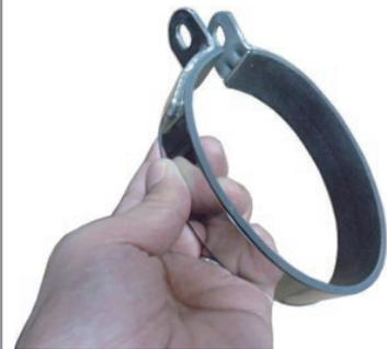
サイレンサーにバンド (44-47mm) を取り付け、サイレンサー ASSY. に差し込みます。
