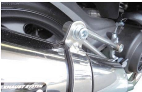
マフラーに付着した汚れを良く拭き取ります。エンジンを始動させ、排気漏れの有無を確認します。
