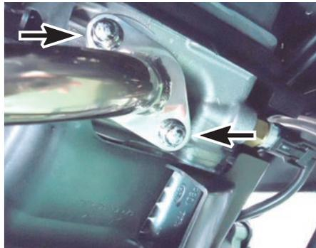
仮付けしたパイプ COMP. ジョイント部に耐熱ガスケット剤を薄く塗布します。
