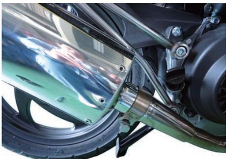
サイレンサー ASSY. ジョイント部のバンド (44-47mm) を規定トルクまで締め付けます。
