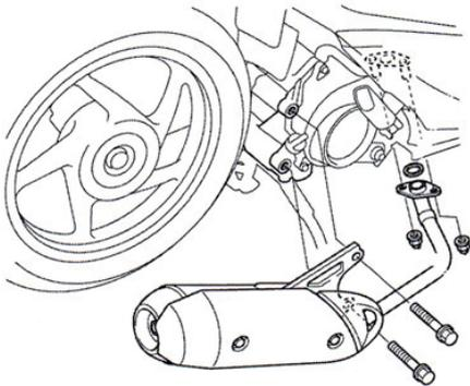
サイレンサーステーをキット同梱のソケットキャップスクリュー 10x30にて取り付け、規定トルクまで締め付けます。
