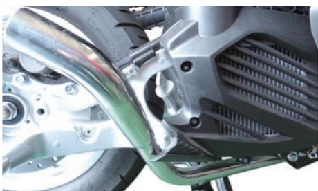
ステー COMP. をキット同梱のソケットキャップスクリュー 10X55 2 個を用いて取り付け、規定トルクまで締め付けます。
