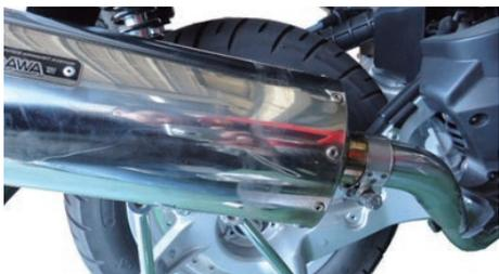
サイレンサーバンドでサイレンサー ASSY. を挟み込む様にステア COMP. の前方の 10mm ネジ穴部に付属のソケットキャップスクリュー 10X45 にブレンワッシャ 10X25X2.3 及びブレンワッシャ 10mm を取り付け、サイレンサーバンドを仮締めします。
