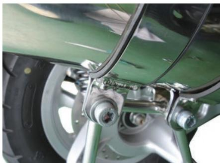
仮付けが完了すれば、サイレンサー ASSY. パイプ COMP. に無理な力が掛からない様位置を調整し各部のクリアランス等を確認します。
