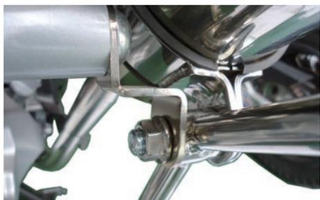
パイプ COMP. フランジ部エキゾーストパイプナットを均等に規定トルクまで締め付けます。
