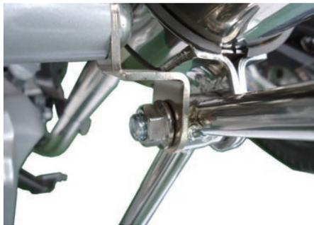
サイレンサーバンドでサイレンサーを挟み込む様にステア COMP. の後方の 10mm ネジ穴部に付属のソケットキャップスクリュー 10X25、ブレンワッシャ 10mm を取り付け、サイレンサーバンドを仮締めします。
