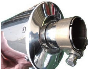
仮付けしたパイプ COMP. ジョイント部に耐熱ガスケット剤を薄く塗布し、サイレンサー ASSY. をパイプ COMP. に差し込みます。
