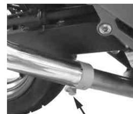
サイレンサー部のクランプバンドを規定トルクまで締め付けます。バンド部には、焼き付き防止剤を少量塗布することを推奨します。
