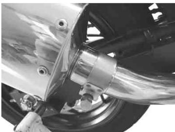
サイレンサーバンドにサイレンサーバンドラバーを取り付け、サイレンサーに通し、マフラスター部にキット内のソケットキャップスクリュー 10 x 25、フランジナットを用いて取り付けます。
