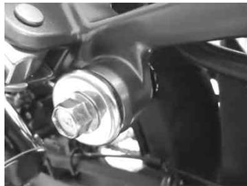
サイレンサーバンド部のソケットキャップスクリューを規定トルクまで締め付け、マフラークランプボルトを規定トルクまで締め付けます。
