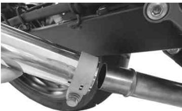
サイレンサーにクランプバンドを取り付け、パイプに差し込み取り付けます。差し込み部に耐熱ガスケット材を塗布することを推奨します。
