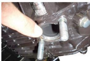
5. エキゾーストポート部の古いエキゾーストパイプガスケットを外し、キット内の新品のエキゾーストパイプガスケットを取り付けます。
