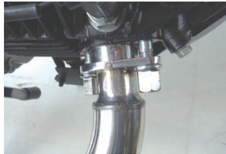
マフラー COMP. ステア部のフランジボルト 8X30 を規定トルクまで締め付けます。
