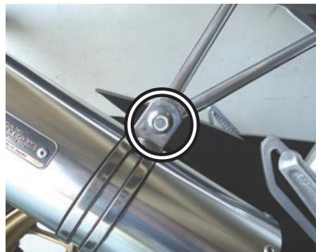
サイレンサー部のプレートの保護フィルムを剥がします。
