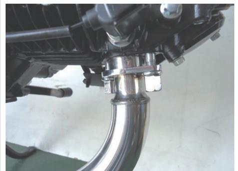
マフラー COMP. ステア部にキット内のカラー1をステアとフレームとの間に挟みキット内のフランジボルト 8X30 を用いて取り付け仮締めします。
