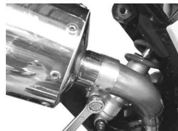
10. サイレンサー部のネームプレートの保護フィルムを剥します。
