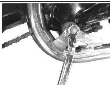
8. サイレンサーバンド部のソケットキャップスクリューを規定トルクまで締め付けます。
