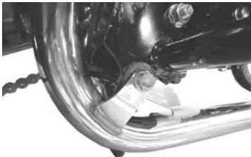
3. キット内のバンド(44 47mm)をサイレンサーCOMP.のパイプジョイント部に取り付け、パイプCOMP.に差し込み取り付けます。
