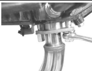
7. パイプCOMP.ステー部のボルトを規定トルクまで締め付けます。
