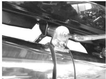
9. サイレンサーCOMP.のパイプジョイント部バンド(44 47mm)を規定トルクまで締め付けます。
