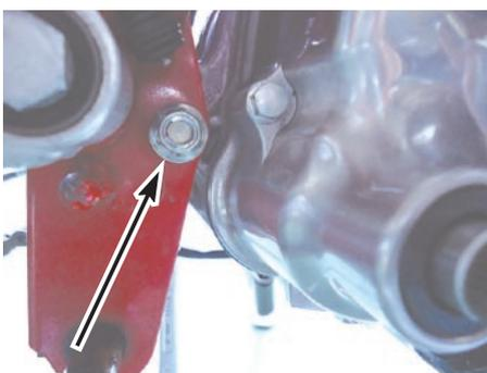
6. フレームのブレーキロッドに、キット内のトルクロッドブラケットCOMP.を取り付け、エンジンマウントのナットを取り付け規定トルクまで締め付けます。
