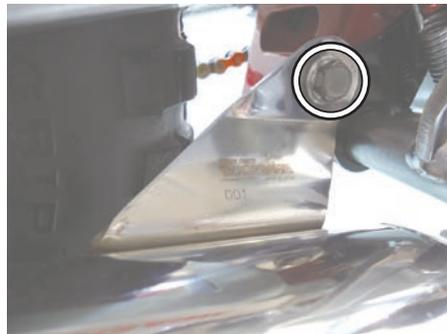
14. サイレンサー COMP. のジョイント部のバンド (32-35mm) を規定トルクまで締め付けます。
