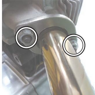
13. サイレンサー COMP. ステア部のフランジ 6 角ボルト 8x16 を規定トルクまで締め付けます。
