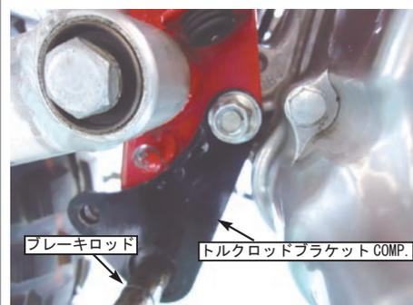
7. ブレーキロッドに、ブレーキペダル、ブレーキスイッチスプリング、ブレーキペダルスプリング、ワッシャを取り付け、キット内のスナップピンをブレーキロッドに差し込みブレーキロッドを固定させます。
