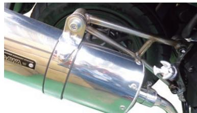
8. 取り付けた各部を規定トルクで締め付けます。
