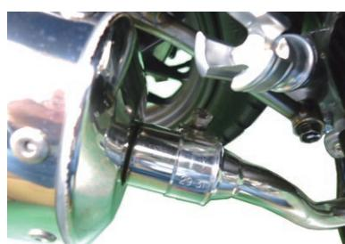
7. サイレンサーバンドにバンドラバーを巻き付けてサイレンサーに通し、サイレンサーステーにプレーンワッシャ 8mm 2枚、ソケットキャップスクリュー 8x50、フランジナット 8mm を用いて取り付け仮締めします。
