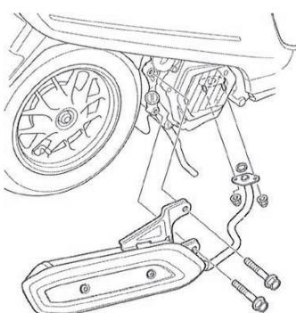
2. サイレンサーステーにマウンティングラバー及びマウンティングカラーを取り付けます。
