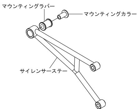
3. サイレンサーステーを取り付け、規定トルクで締め付けます。
