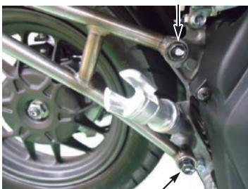
4. キット付属のガスケットを取り付け、エキゾーストパイプを取り付け、手でナットをいっぱいまで仮締めします。
