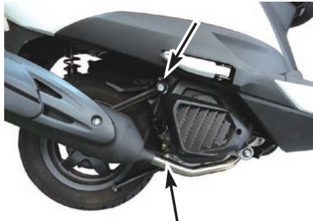
4. エキゾーストパイプフランジ部のエキゾーストパイプジョイントナットを均等に規定トルクまで締め付けます。
