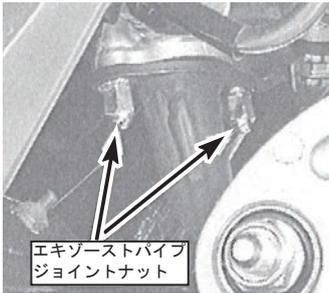
2. キット付属のガスケットを取り付け、エキゾーストパイプを取り付け仮締めます。
