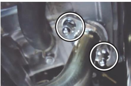
5. マフラー COMP. 上下ステー部のマフラーマウントボルトを規定トルクまで締め付けます。
