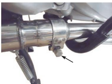
12. フレームのセンタースタンドストッパー部が当たる部分にキット同梱のラバープレートフレームに貼り付け、両サイドをインシュロックタイでロックし、余った先端をニッパ等で切断します。
