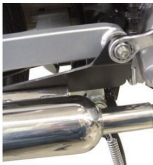
9. ステー部のフランジボルトを規定トルクまで締め付けます。
