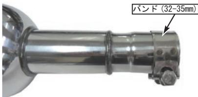
6. サイレンサー COMP. ジョイント部のマフラーパッキンに、エキゾーストパイプストッパー部に当たるまで差し込み、リアアクスルシャフト部に、ステーを下記写真を参考に取り付け仮締めします。
