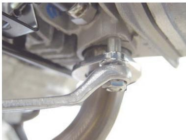
8. リアアクスルスリーブナットを規定トルクまで締め付けます。
