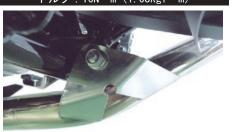
19. タンデムステップ部のフランジボタンソケットスクリューを規定トルクまで締め付けます。
