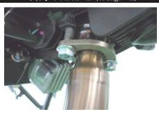
18. フレームに取り付けたステー部のフランジ ナットを規定トルクまで締め付けます。
