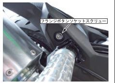
20. クランプバンド部のソケットキャップスクリューを規定トルクまで締め付けます。
