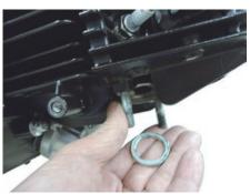
10. キットのマフラー COMP. エキゾーストパイ プ部をエキゾーストポート部に取り付け純正 ナットで仮締めします。
