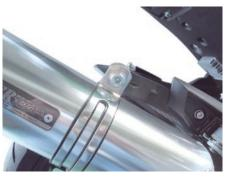
21. マフラー COMP. ボス部に 02 センサーを取り 付け規定トルクまで締め付けます。
