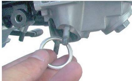
5. 右側リアショック上部のナットを取り外し、キット内のピボットナットを取り付け、規定トルクまで締め付けます。
