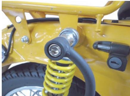
14. ステアCOMP. 下部、サイレンサーステー側のソケットキャップスクリュー8x25を規定トルクまで締め付けます。
