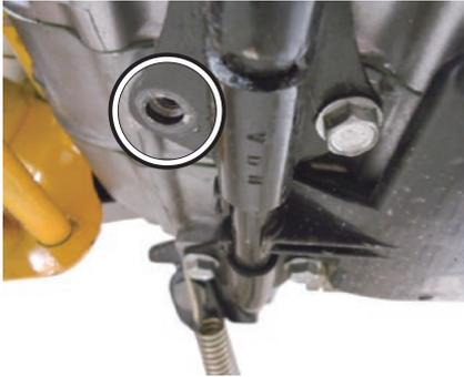
10. 取り外した位置に、キット内のカラー/ステー/フランジボルト8x25を用いて仮締めします。
