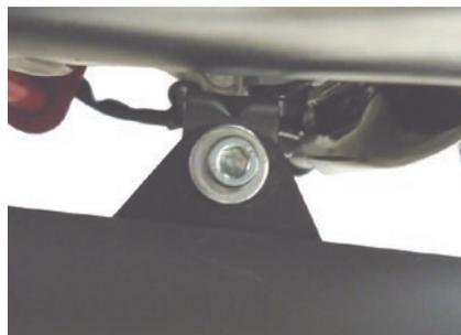
16. ステップバーに取り付けたステー部のフラジソケットキャップスクリュー8x25を規定トルクまで締め付けます。
