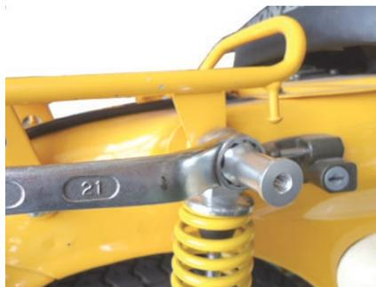
6. キット内のステー-COMP. をピボットナットに、ソケットキャップスクリュー-8x25 を用いて仮締めします。
