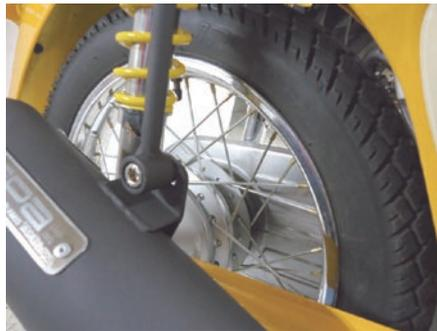
15. エキゾーストパイプ部ステーのソケットキャップスクリュー6x15を規定トルクまで締め付けます。
