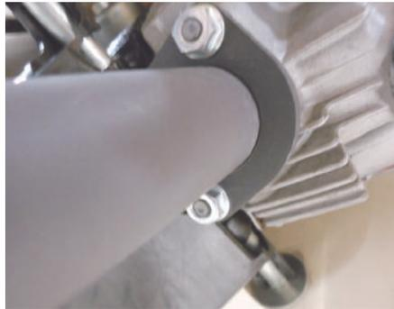
13. ステアCOMP. 上部のソケットキャップスクリュー8x25を規定トルクまで締め付けます。
