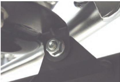
12. エキゾーストパイプフランジ部の純正ナットを均等に既定トルクまで締め付けます。
