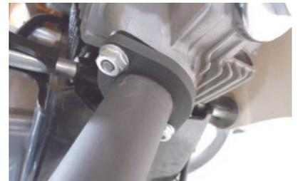
8. マフラー-COMP. サイレンサー部のステーをステー-COMP. にソケットキャップスクリュー-8x25、及びフランジナット8mmを用いて仮締めします。
