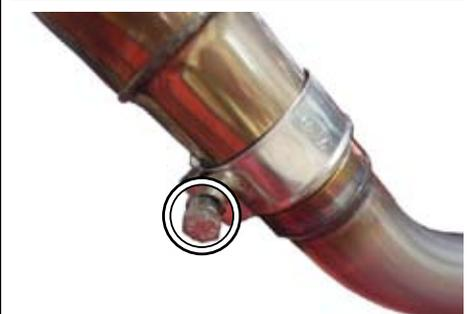
○①サイレンサー COMP. ジョイント部の⑫バンド (44-47mm) を規定トルクまで締め付けます。
