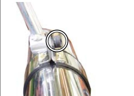
○②パイプ COMP. ジョイント部の⑪バンド (36-39mm) を規定トルクまで締め付けます。
