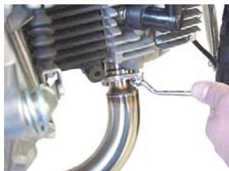
○マフラスター上部の⑧ソケットキャップスクリュー 8x25 を規定トルクまで締め付けます。
