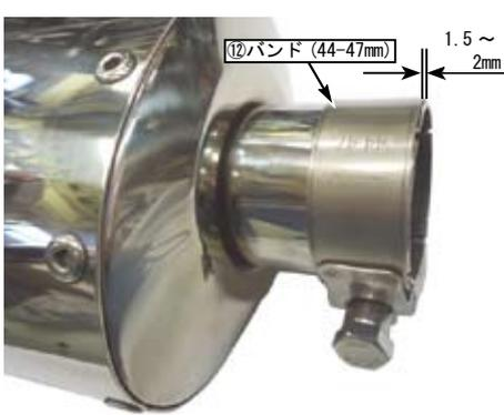
○②パイプ COMP. に①サイレンサー COMP. を差し込み、サイレンサーを取り付けます。
