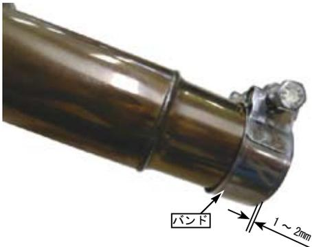
○③エキゾーストパイプ COMP. ジョイント部に耐熱ガスケット材を薄く塗布します。
