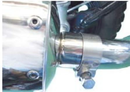
○④サイレンサーバンドに⑤サイレンサーバンドラバーを巻き付け、付属の⑨ソケットキャップスクリュー 10x25、⑩プレーンワッシャ 10mm で⑥マフラスター COMP. に取り付けます。
