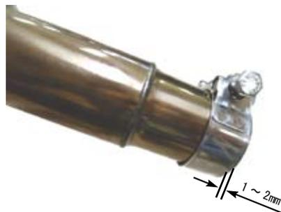
○仮付けたエキゾーストパイプ COMP. ジョイント部に排気漏れ防止の為、耐熱ガスケット剤を薄く塗布し、マフラー ASSY. をエキゾーストパイプ COMP. に差し込む。
