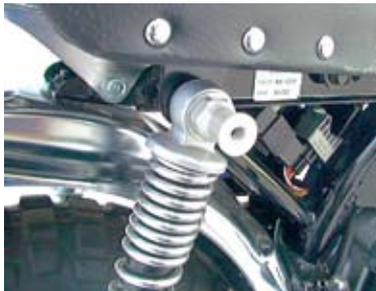
○サイレンサーステーをピボットナットに、フランジソケットキャップスクリュー 8x16 を用いて仮締めをする。
