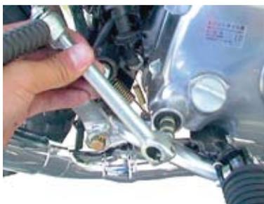
○弊社製キックスターターアームを付属のキャップスクリューを用いて取り付け、規定トルクまで締め付ける。
