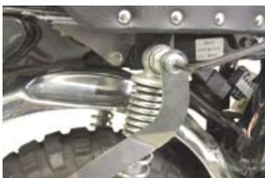
○クランプバンド部のフランジソケットキャップスクリュー 8x20 を規定トルクまで締め付ける。
