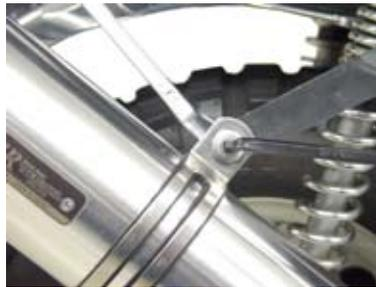
○パイプジョイント部のバンド (36-39mm) を規定トルクまで締め付ける。
