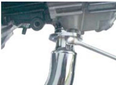
○ピボットナット部のフランジソケットキャップスクリュー 8x16 を規定トルクまで締め付ける。
