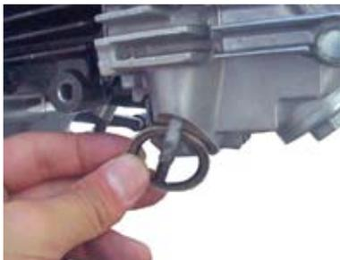
○取り外したエアクリナーを、取り外しと逆手順で取り付ける。
