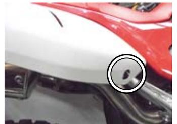
○エンジンを始動させ、排気漏れの有無を確認します。
