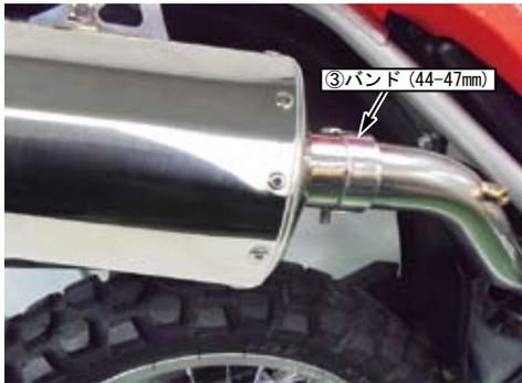
○②パイプ COMP. 部のエキゾーストパイプマウントボルト及び①サイレンサー ASSY. ステア部にサイレンサーマウントボルトを用いて取り付け仮締めします。
