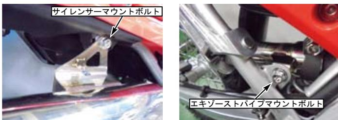
○②パイプ COMP. のエキゾーストパイプマウントボルトを規定トルクまで締め付けます。
