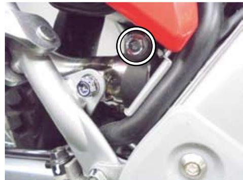
○①サイレンサー ASSY. のパイプジョイント部③バンド (44-47mm) を規定トルクまで締め付けます。
