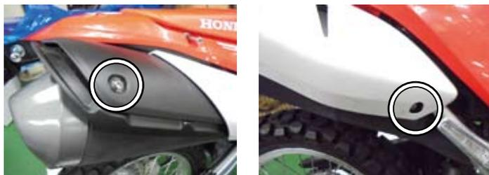
○マフラーバンド部のフランジボルト、エキゾーストパイプマウントボルト及びサイレンサーマウントボルト、ナットを外し、ノーマルマフラーを取り外します。
