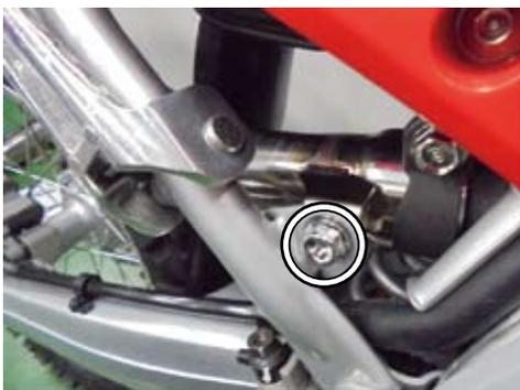
○①サイレンサー ASSY. ステア部のサイレンサーマウントボルトを規定トルクまで締め付けます。
