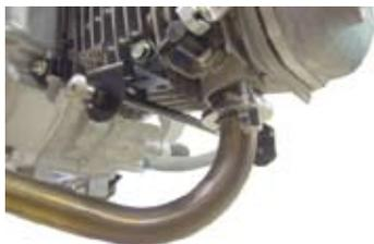
○キット内のステーとサイレンサー COMP. をキット内のフランジ六角ボルトを用いて取り付け、仮締めします。
