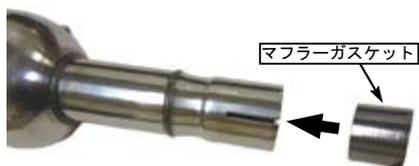
○サイレンサー COMP. ジョイント部に、キット内のバンドを取り付け仮締めします。
