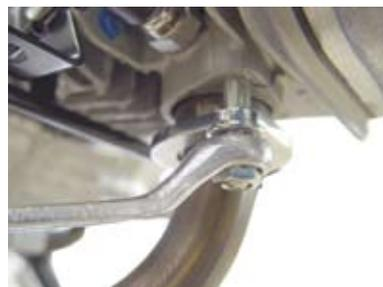
○リアアクスルスリーブナットを規定トルクまで締め付けます。
