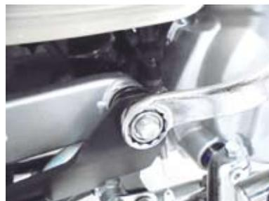
○ステー部のフランジ六角ボルトを規定トルクまで締め付けます。
