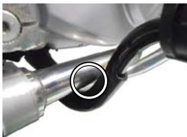
○シリンダーヘッドエキゾーストポート部のジョイントナットを規定トルクまで均等に締め付けます。
