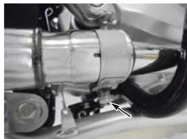
○フレームのセンタースタンドストッパー部が当たる部分にキット同梱のラバープレートフレームに貼り付け、両サイドを結束バンドでロックし、余った先端をニッパ等で切断します。
