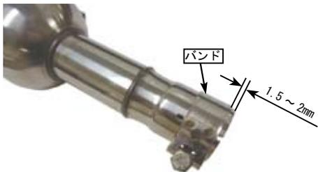
○サイレンサー COMP. ジョイント部をパイプ COMP. に差し込み、リアアクスルシャフトに、ステーを、下記写真を参考に取り付けリアアクスルナットを仮締めします。
